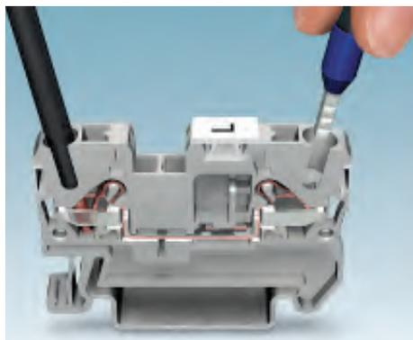
Благодаря технике подключения Push-In к клеммам серии DT можно легко подсоединять однопроволочные провода. При вставке жесткого провода в пружинный зажим пружина автоматически отжимается.
