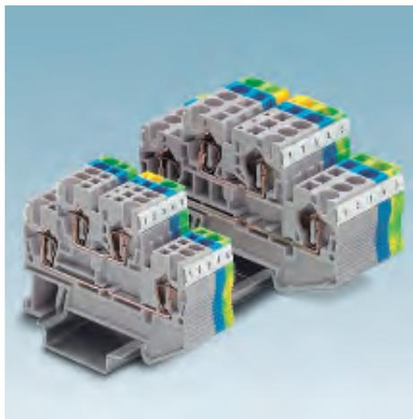
По сравнению с одноярусными двухъярусные клеммы STTB позволяют достичь сокращения монтажного пространства до 50 %. Для решения различных схмотехнических задач в клеммах серии STTB для обоих ярусов используется система перемычек FBS. Маркировочные элементы легко различимы и маркируют каждый вывод клеммы.
