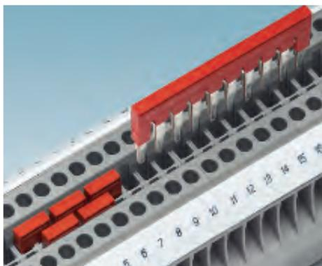
Два ряда шунтирования позволяют объединить двухвыводными перемычками любое количество клемм. С помощью перемычек на 2-50 выводов можно за один раз соединить до 50 клемм.
