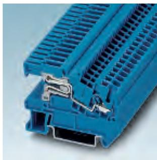
Клеммы с ползунковым контактом для коммутируемого подключения к нулевой рабочей шине с присоединением проводников без инструмента (Push-In)
