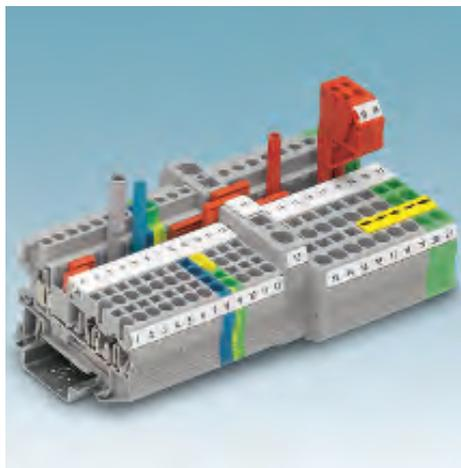
Серия клемм ST с пружинными зажимами Mini-Spring расширена комбинированными пружинными клеммами ST...-TWIN. Размеры отверстий для ввода провода как со стороны пружинных зажимов, так и со стороны винтовых позволяют подсоединять провода (с наконечниками или без них) номинальным сечением 2,5 мм<sup>2</sup> и 4 мм<sup>2</sup>.
