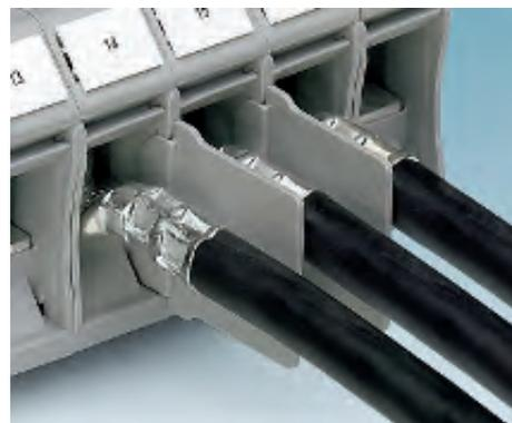
К клеммам RT и RTO могут подключаться также неизолированные кабельные наконечники. Для цепей высокого напряжения, на клеммы устанавливаются разделительные перегородки BE-RT.
