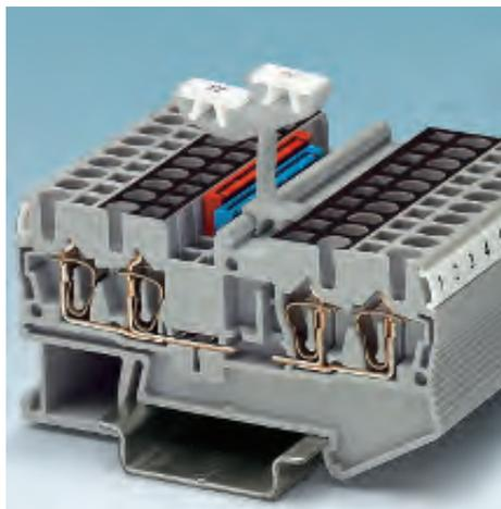
Данные четырехвыводные пружинные клеммы являются двухполюсными, т.к. выводы, расположенные по разные стороны клеммы электрически не соединены. По существу, эти клеммы представляют собой два ряда расположенных в одном уровне двухвыводных клемм. Выводы клемм ST...QUATTRO-U можно соединять перемычками FBS.
