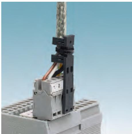
Компоненты PSH... предлагают решение для подсоединения экранированных проводов. PSH... защелкивается после монтажа клемм в PZ/... или PRZ, после чего окончательно фиксируется хомутом для стяжки кабелей. Соединительный кабель PSH... подключается к штекеру, а в нем контактирует непосредственно с клеммой.
