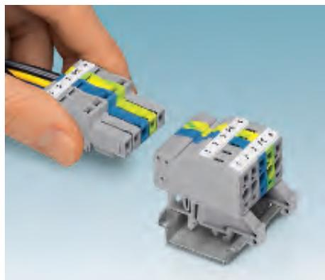
Вариант соединителя для установки на монтажную рейку предназначен для устройств с уменьшенной высотой. Встроенные специальные монтажные основания Duo позволяют устанавливать соединители как на шину NS 15, так и на шину NS 35.
