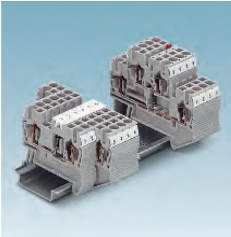
Имея небольшую ширину (всего 5,2 мм), клеммы со встроенными элементами и пружинными зажимами номинальным сечением 2,5 мм<sup>2</sup> позволяют решать широкий спектр электромонтажных задач. Диод может быть установлен в корпусе клеммы как слева-направо, так и наоборот. Многопроводные схемы подключения реализуются с помощью трех- и четырехвыводных клемм. Максимальный выпрямленный ток клемм ST 4-QUATTRO-DIO с диодом 1N 5408 составляет 1,5 А.
