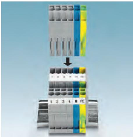
В каждой наборной вилке обязательно должны быть крайний левый и крайний правый компоненты. Число средних компонентов определяется количеством выводов вилки. Компоненты крепятся друг к другу с помощью защелок.
