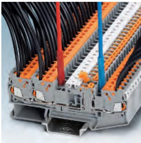
Стандартом в современной контрольно-измерительной технике стали проходные клеммы с возможностью размыкания. Клеммы QTC...-MT комплектуются несъемным ножевым размыкателем, их нагрузочная способность составляет 20 А. Еще одна особенность - это наличие в каждой клемме трех рядов для шунтирования. Два из них расположены рядом (как у стандартных клемм QT и ST), а третий находится по другую сторону от разрыва цепи.
