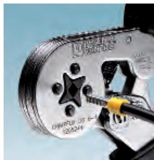
Клещи для обжима кабельных наконечников и крышки для отдельных клемм
