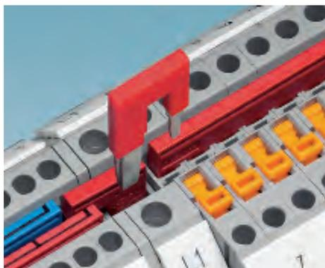
С помощью перемычек переходного сечения можно легко соединять клеммы с разным номинальным сечением, например, UT 10 с UT 2,5. Кроме того, использование перемычек переходного сечения позволяет без труда реализовывать схемы ввода электропитания.
