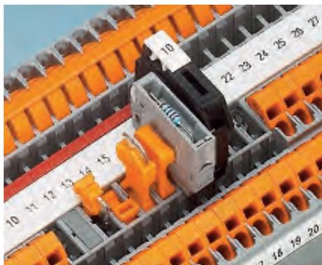
Клеммы с разрывом цепи имеют зону со стандартными гнездами для установки штекерных заглушек-перемычек P-FIX, перемычек для оперативного размыкания цепи P-DI, штекерных модулей P-CO и штекерных держателей предохранителя P-FU.
