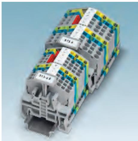
Для пружинных клемм общего назначения ST-DESK предусмотрены аналогичные по профилю заземляющие клеммы. Надежный электрический и механический контакт с монтажной рейкой обеспечивается простым защелкиванием. При этом полностью соблюдаются требования стандарта МЭК 60947-7-2.
