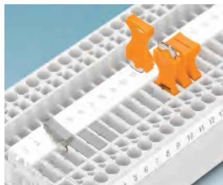
Ножевая вставка P-DI позволяет оперативно коммутировать цепь. При этом после размыкания цепи допускается поместить P-DI в зону размыкания "вверх ногами" для индикации статуса цепи. Вставка заглушка P-FIX устанавливается заподлицо и является обычной проходной вставкой.
