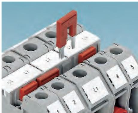
С помощью перемычек переходного сечения можно легко соединять клеммы с разным номинальным сечением, например, RT 8 с RT 3. Кроме того, использование перемычек переходного сечения позволяет без труда реализовывать схемы ввода электропитания.
