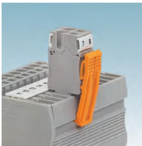
Защелка PR... может применяться во всех вариантах штекеров. Она в виде опции закрепляется в корпус штекера снаружи и при защелкивании штекера фиксируется в корпус клеммы.
