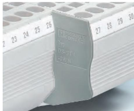
Если в клеммной группе рядом с двухвыводной клеммой располагается клемма с тремя или четырьмя выводами, то выступающая часть многовыводной клеммы закрывается специальной торцевой крышкой, которая служит для защиты от случайного прикосновения к токоведущим частям.
