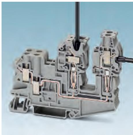
Так же как и в базовых клеммах в штекерах могут использоваться любые способы подключения. Резьбовые штекеры разъемов COMBI поставляются в двух вариантах. Для штекерных модулей UPBV... предусмотрена возможность установки перемычек. Проводники подсоединяются сбоку. Винты зажимаются сверху. Эти модули позволяют очень компактно прокладывать подсоединенные проводники непосредственно в кабельном канале. Перемыкание контактов производится с помощью стандартных перемычек FBS....
