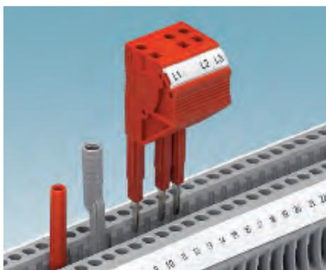
Для подключения отдельных проводов измерительных устройств поставляются тестовые штекеры 2,3-мм. Адаптер для тестового штекера диаметром 4-мм и наборные тестовые вилки позволяют быстро реализовать любые измерительные схемы.
