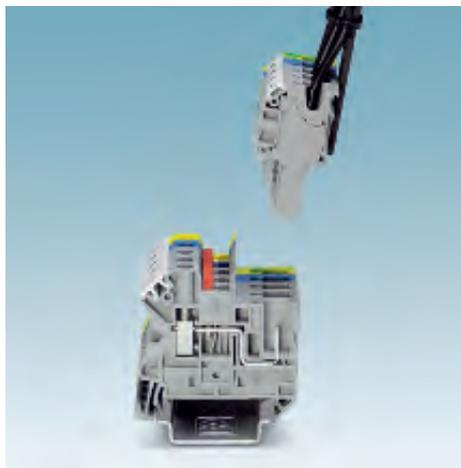
Система штекерного подключения COMBI позволяет соединять винтовые клеммы UT с номинальным током до 32 А и номинальным напряжением до 800 В. Конструкция разъемного соединения клемм COMBI исключает контакт пользователя с токоведущими частями как со стороны клеммной, так и кабельной части.
