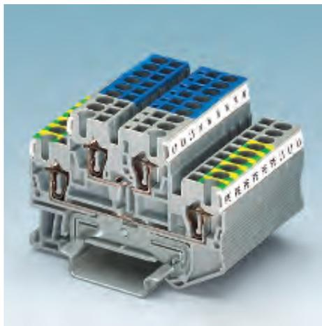
Эти смешанные варианты возникли из комбинации двухъярусных и проходных клемм и заземляющих клемм одинаковой формы. Типы PE/L- или PE/N на нижнем ярусе выполняют функцию заземления при установке на монтажной рейке. Верхний ярус является проходным ярусом. Благодаря цветному обозначению ярусов PE- и N, существует возможность точного и видимого распределения потенциалов.
