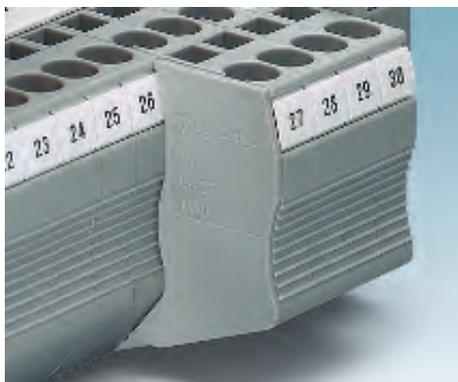
Если в клеммном блоке рядом с двухвыводной клеммой располагается клемма с тремя или четырьмя выводами, то выступающая часть многовыводной клеммы закрывается специальной торцевой крышкой, которая служит для защиты от случайного прикосновения к токоведущим частям.
