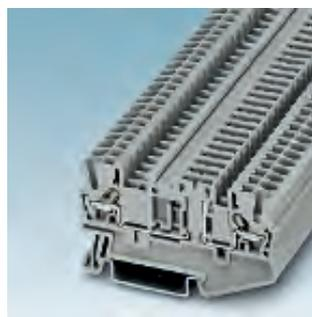
Клеммы с подсоединением проводников без инструмента (Push-In), с разрывом цепи и возможностью размещения вставок
