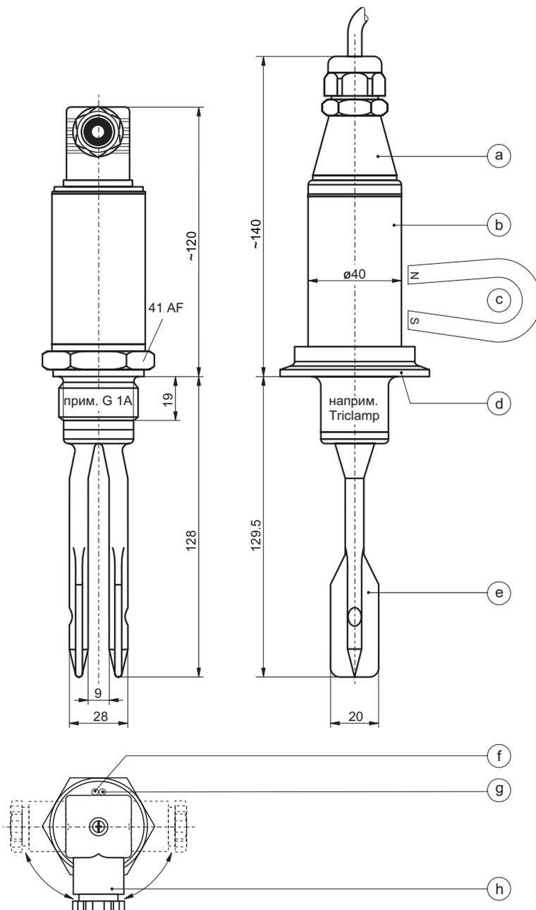
а) Электрическое подключение через стандартный разъем и с кабельным вводом Pg 11 (IP 65 / 67) или с установленным кабелем (IP 68). Алгоритм срабатывания определяется схемой подключения.
