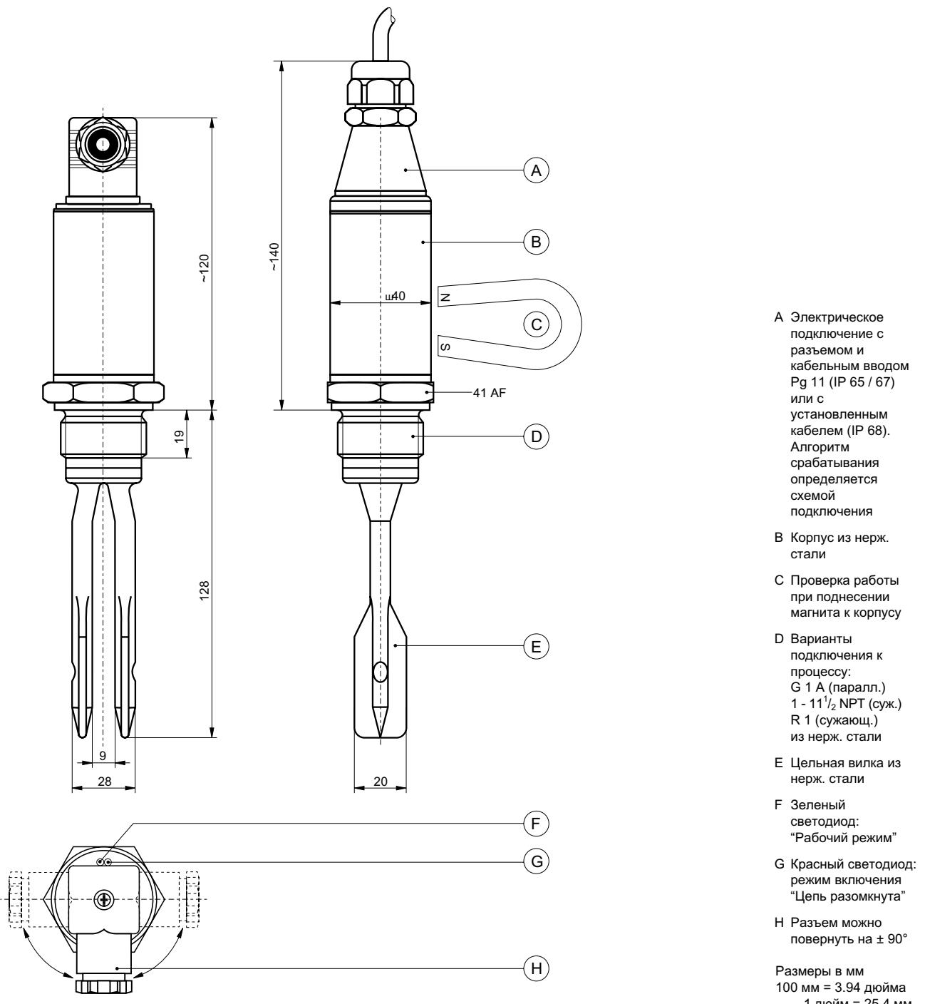
A Электрическое подключение с разъемом и кабельным вводом Pg 11 (IP 65 / 67) или с установленным кабелем (IP 68). Алгоритм срабатывания определяется схемой подключения
