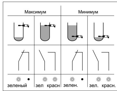
Рисунок показывает срабатывание **электронного ключа** и светодиода в зависимости от уровня безопасности
