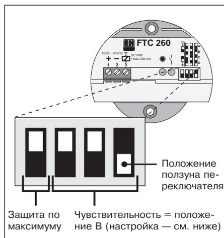
Заводские установки на DIP-переключателе
